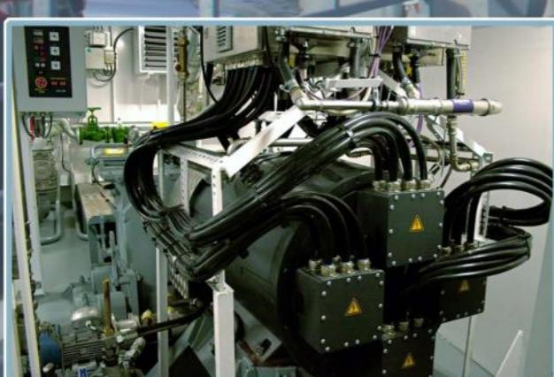
Batterierne leverer strøm til de to hovedmotorer og bøvthrustere.
